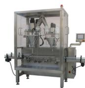
DH-Q3-D 型自动罐装机 (单排双充填)
